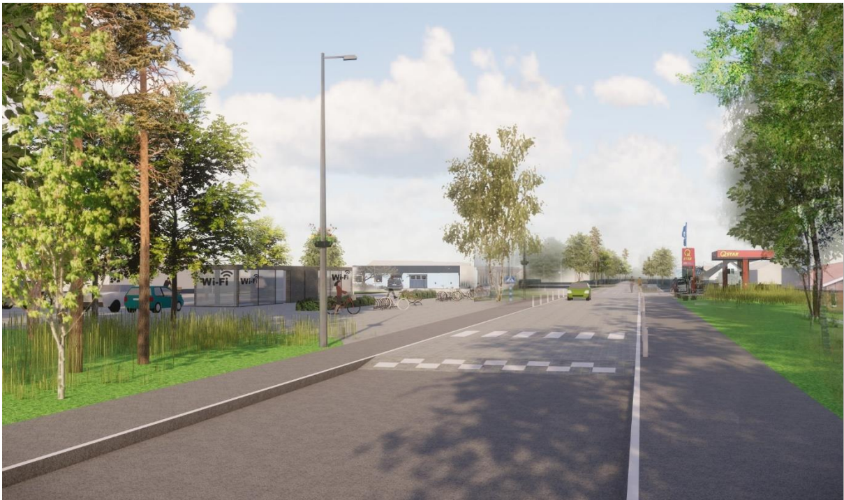
Bild 23: En upphöjning av vägen vid Grimsås torg fungerar hastighetsreducerande, samt skapar ett mer sammanhängande torgområde
